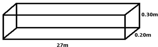
$$V_{\text{concreto}} = 27 \cdot 0,30 \cdot 0,20 = 3,24 \text{ m}^3 \text{ de concreto.}$$
