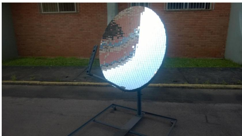
Figura 1 – Concentrador parabólico construído.
