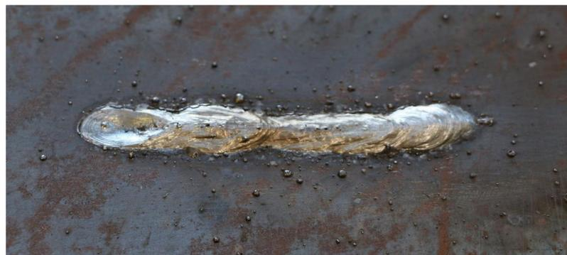
Figura 3 – Cordão de solda feito com a máquina.
