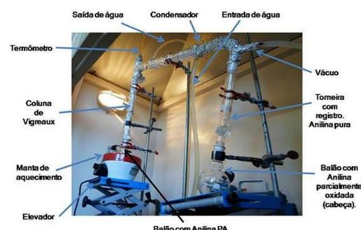
FIGURA 2 – Aparato experimental utilizado para a destilação da anilina.
