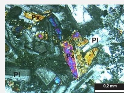
Fig. 2: Rocha II: basalto - fenocristal de clinopiroxênio (augita - Px) com macla lamelar. À direita, após cristal de plagioclásio (PI), matriz fina (quartzo + feldspato potássico).
