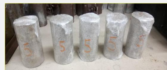
Figura 1: Corpos de prova com metacaulim.
