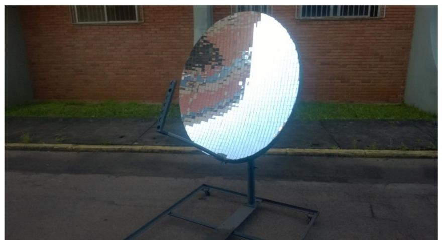
Figura 2 – Concentrador parabólico construído.
