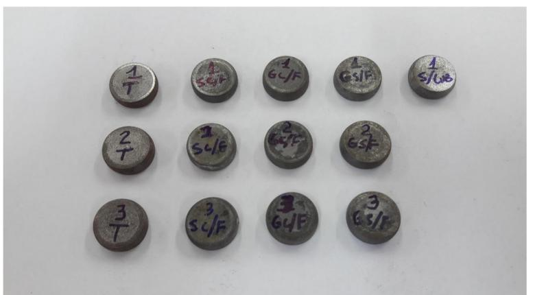
Figura 2 – Corpos de prova após o ensaio de compressão.
