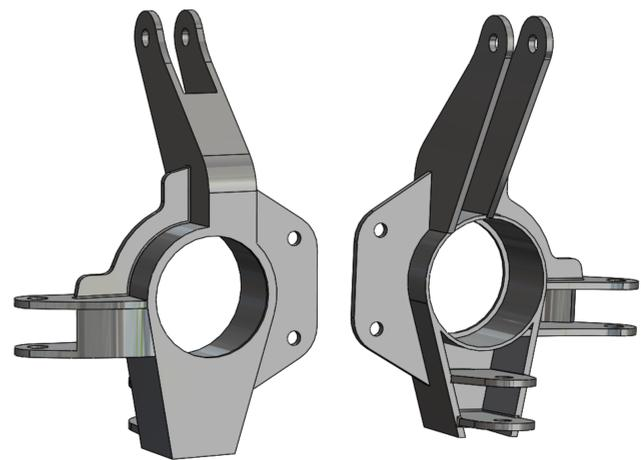
Figura 3 : Montante de roda dianteiro desenhado no software Solidworks.
