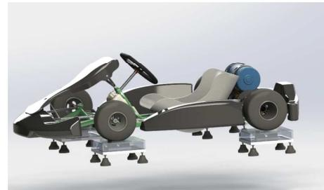
Figura 2 – Balanças para medição da distribuição de massas .
