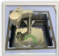
O grau de conversão foi avaliado por meio da técnica de Espectroscopia de Infravermelho com Transformada de Fourier (FTIR). O espectrofotômetro (VERTEX 70, Bruker Optics, Ettingen, Alemanha) foi acoplado ao dispositivo ATR, formando um ângulo de 45° com o espelho. Um detector de infravermelho foi utilizado para capturar o infravermelho refletido. Foram obtidos espectros de absorvância antes e imediatamente após a fotoativação. O grau de conversão foi medido através da fórmula a seguir:
