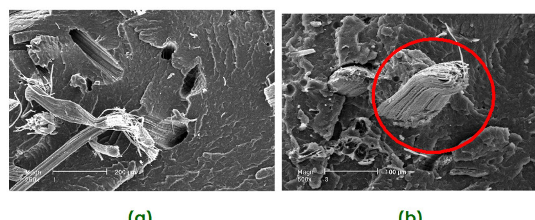
Seções transversais do Compósito PP com fibra de curauá após ensaio de tração: (a) parte com "pull-out" das fibras e
