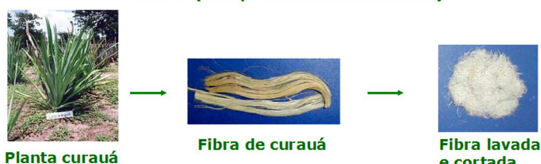
Foi realizada uma pré-mistura do polímero com as fibras (5, 10 e 20% em massa), sendo a mesma cortada e adicionada em injetora HIMACO pura ou com 3% em massa Polybond.
