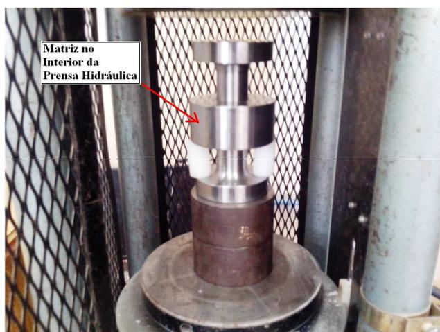
Figura 1. Prensa hidráulica para compactação do SMC.
