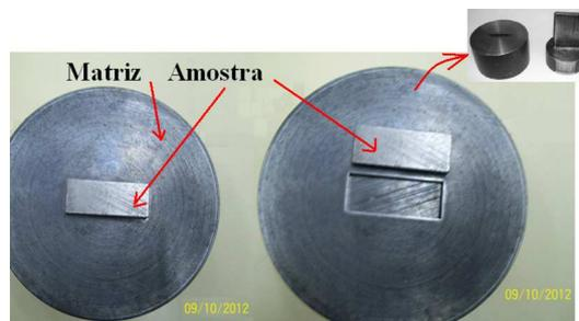
Figura 3. Amostra compactada no interior da matriz e depois de retirada da matriz.
