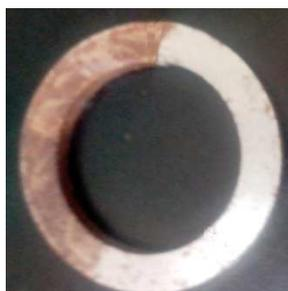
Figura 2. Amostra de SMC no formato toroidal.
