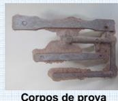
As matrizes biodegradáveis e seus biocompósitos foram submetidos a testes de resistência à tração em Máquina Universal de Ensaio, norma ASTM D638, ensaio de resistência ao impacto (Izod com entalhe), norma ASTM D256 e ensaio de dureza, norma ASTM D2240.
