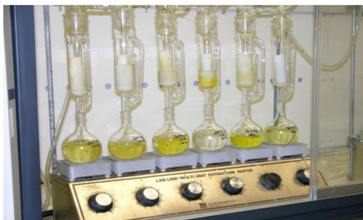
Figura 3: Extração por Soxhlet
