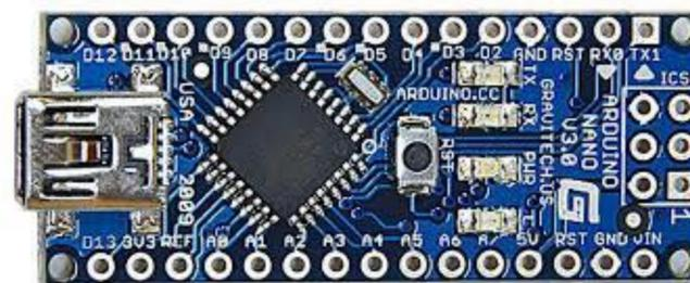
Figura 3: Microprocessador AVR 328p
