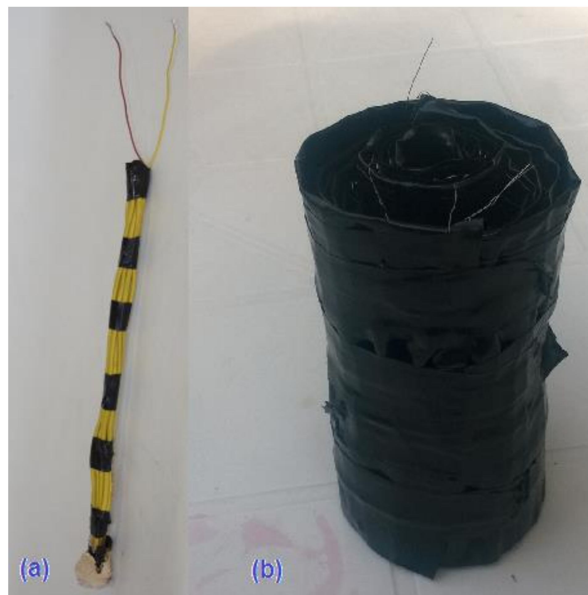
Figura 2 – Módulos termoelétricos 10 pares (a) e 120 pares (b).
