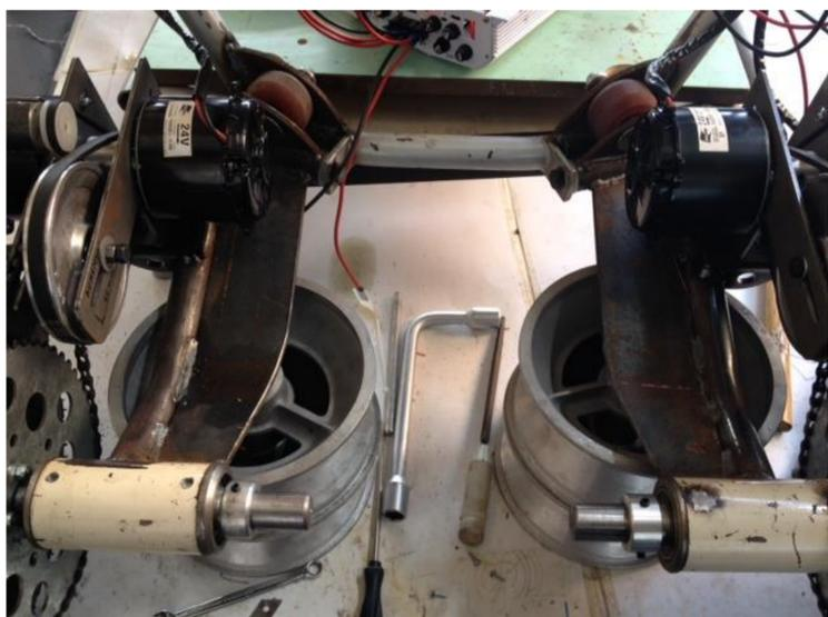
Figura 2: Motores acoplados ao veículo.
