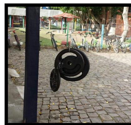
Figura 2: Massa de 18 kg suspensa em fita PET.
