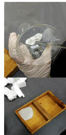
Figura 1 - Recuperação do EPS via química com o uso de propanona
