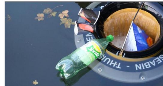
Figura 5. Sistema de coleta de detritos Seabin
